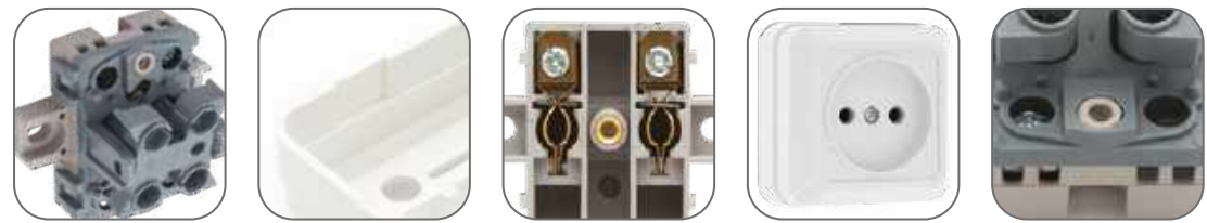
Розетки с пластиковым или керамическим основанием Выштамповки с четырех сторон для подвода кабеля Пластинчатые пружины в контактной группе Корпус из негорючего ABS-пластика Удобное подключение проводников
