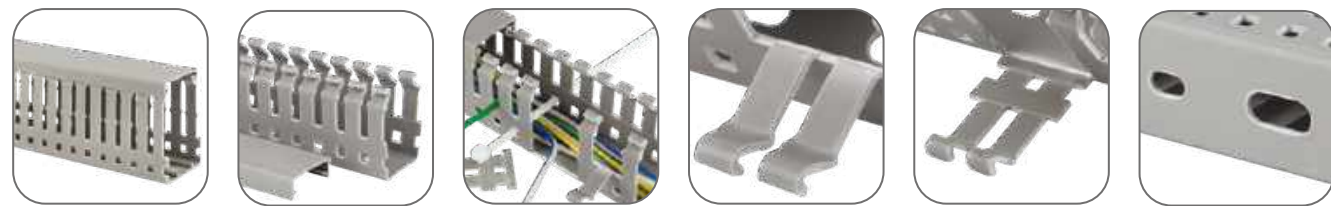
Материал изделия ПВХ Шаг перфорации совпадает с шагом контактных зажимов на модульной аппаратуре Отверстия под стяжки для крепления проводов Специальная линия отлома зубца Специальная линия отлома секции Отверстия в основании разного диаметра
