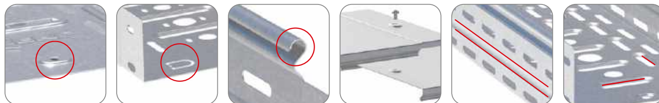
Удобная стыковка лотка и крышки Быстрый монтаж (подкова/проушина) Защита кабеля от повреждения и безопасный монтаж Наличие резьбы в крышке для быстрой сборки Ребро жесткости на стенках лотка Продольная и поперечная подштамповка для увеличения площади охлаждения и придания дополнительной жесткости основанию лотка
